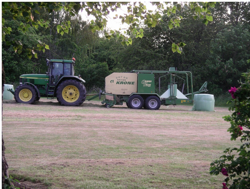
Høet gemmes i wrap-baller. Maskinen kaldes en balle-wrapper!
